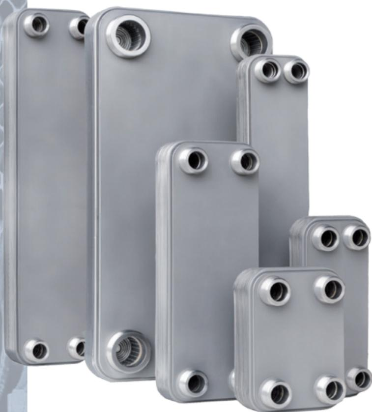
Unsere edelstahlgelöteten Wärmeaustauscher sind trinkwasser-geeignet. Die spezielle, hochmoderne Lötung verhindert unerwünschte Reaktionen auf im Trinkwasser gelöste Kupfer- oder Nickel-Ionen. Somit begrenzen unsere GPL-B die Gehalte dieser Buntmetalle im Rahmen der Trinkwasserverordnung.
