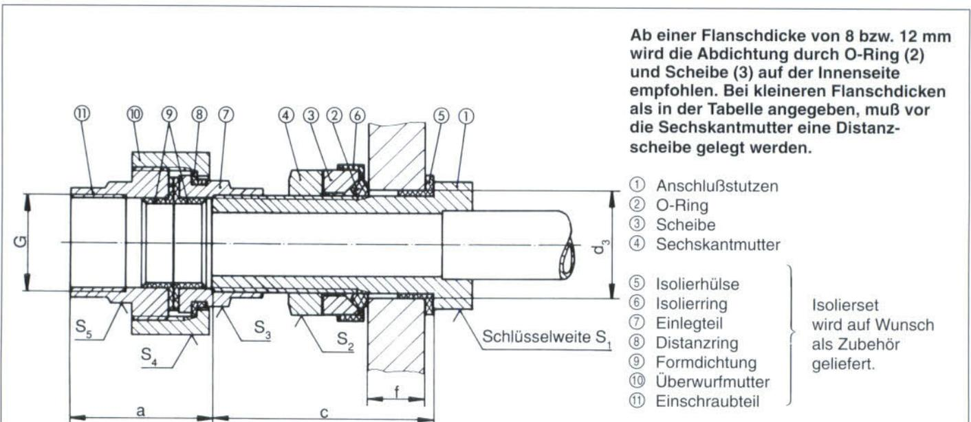
Ab einer Flanschdicke von 8 bzw. 12 mm wird die Abdichtung durch O-Ring (2) und Scheibe (3) auf der Innenseite empfohlen. Bei kleineren Flanschdicken als in der Tabelle angegeben, muß vor die Sechskantmutter eine Distanzscheibe gelegt werden.
